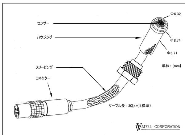
HFM は、試験体に穴を開けてプレスフィットで取り付け、確実に固定するために付属のナットを用います。HFM と専用アンプ AMP-6 をつなぐコネクタには、“4pin Lemo Connector” が使用されています。HFM のケーブル長は標準で 30[cm] ですが、必要に応じて任意のケーブル長を指定して製造することができます。また、特注でスリーピングをより耐熱温度の高い材質に変更することも可能です。特別仕様の HFM につきましては、個別にご対応致しておりますので、詳細は弊社担当者へお尋ねください。
