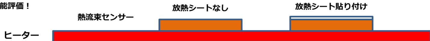
※既知の放射率のコーティングを施した熱流束センサーの計測値と比較することにより、対象物の放射率を測定することが可能です。
